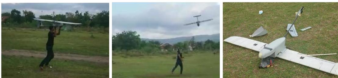
**Gambar 15. Pengujian terbang dan Drop test**
