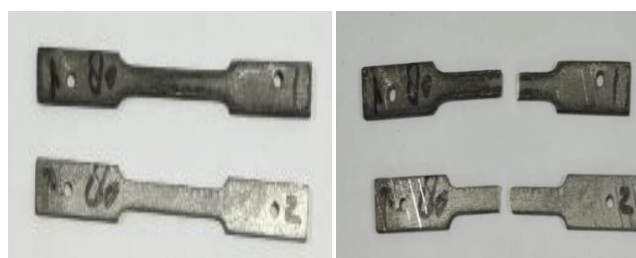
Gambar 3. Sebelum dan Sesudah Uji Tarik sebelum dan sesudah pengujian Tarik.
