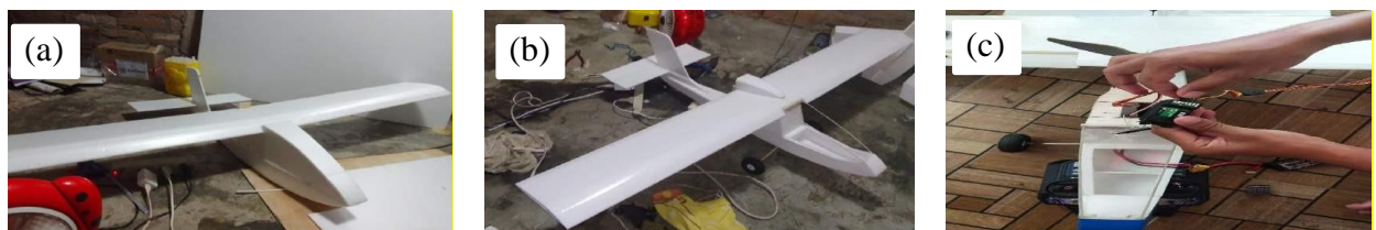
Gambar 11. (a) Penyambungan Seluruh Bagian Komponen, (b) Pemasangan Landing Gear, (c) Pemasangan Elektrikal
