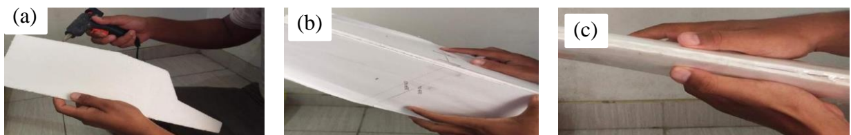
Gambar 8. (a) Pengeleman Polyfoam, (b) Pembentukan Airfoil (c) Penekukan Airfoil
