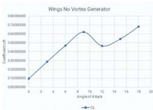
Gambar 2. Grafik hasil simulasi Coefficient Lift terhadap sudut serang airfoil NACA 2410
