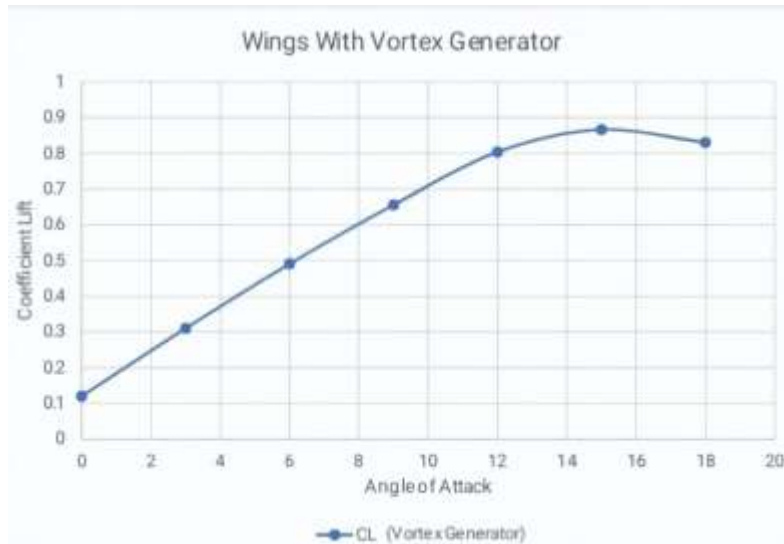
Gambar 4. Grafik hasil simulasi Coefficient Lift terhadap sudut serang airfoil NACA 2410
