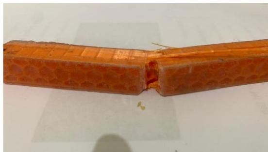
**Gambar 3. Spesimen Komposit 50% Serat dan 50 % resin Setelah Diuji**
