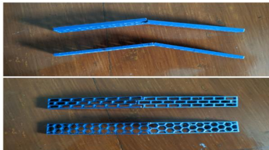
Gambar 3. Core Honeycomb dan Rectangular Tanpa Skin Setelah Diuji
