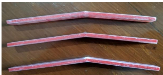
Gambar 1. Spesimen Komposit Core Honeycomb Setelah Diuji
