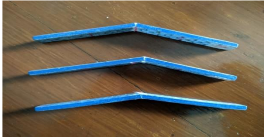
Gambar 2. Spesimen Komposit Core Rectangular Setelah Diuji
