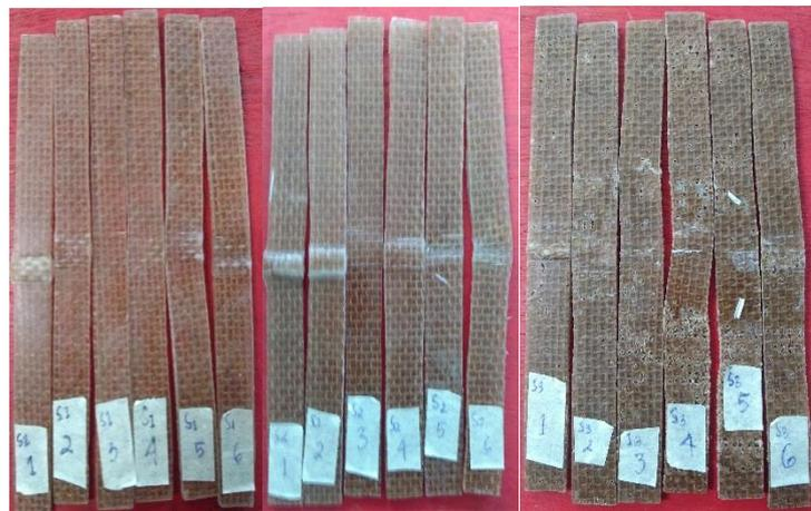
**Gambar 4. Setelah Dilakukan Uji Tekan Pada Spesimen Variasi Lapis Serat 1, 2, Dan 3**
