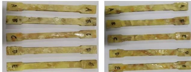
Gambar 2. Spesimen Komposit Uji Tarik
