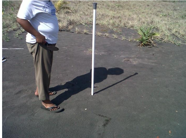
Gambar 5 Proses pipa ditancapkan ke pasir
