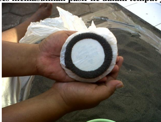
Gambar 9 Proses pemisahan pasir besi non magnetik dengan pasir besi magnet
