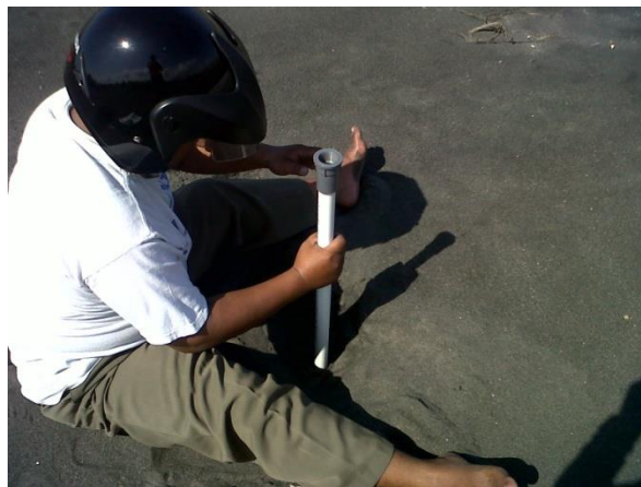
Gambar 6 Pipa dimasukkan ke pasir sampai kedalaman empat meter
