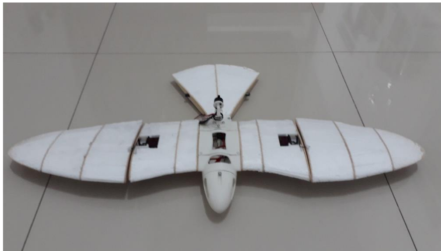
Gambar 4. Hasil perakitan semua komponen purwarupa UAV meniru bentuk burung.
