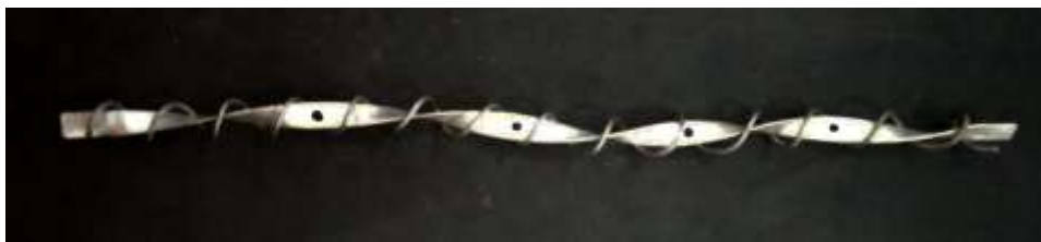
Gambar 4. Vortex generator tipe twist with hole dengan penambahan wire coil
