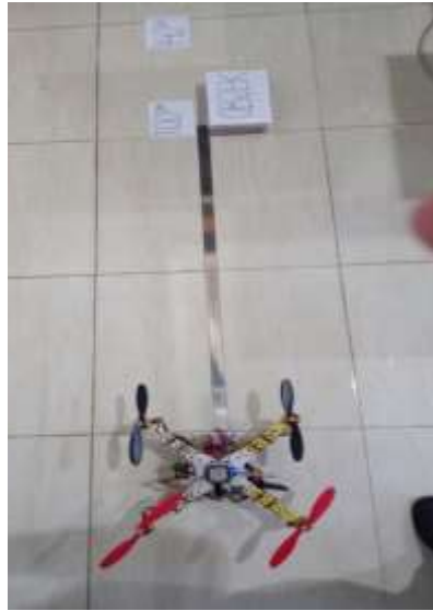
Gambar 2. Pengujian Cara Kerja Sistem Sensor Jarak Ultrasonik HC-SR04 pada Jarak Aman Maksimal 100cm
