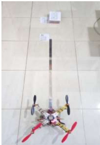
Gambar 3. Pengujian Cara Kerja Sistem Sensor Jarak Ultrasonik HC-SR04 pada Jarak Aman 140cm
