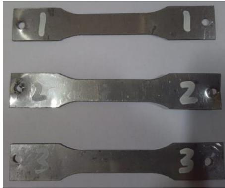
**Gambar 2. Hasil pemotongan aluminium berdasarkan ASTM**
