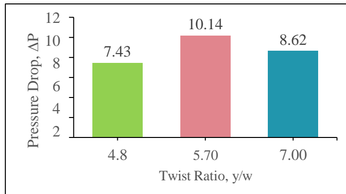
Gambar 10. Grafik pengaruh geometri double v-cut twist terhadap pressure drop pada beban rata-rata
