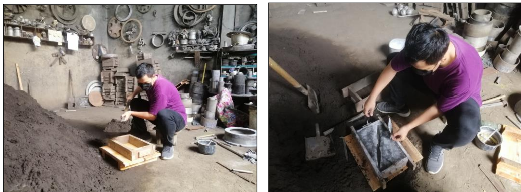
Gambar 3. Proses Pembuatan Cetakan Propeller
