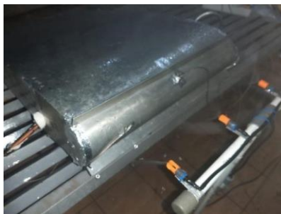
Gambar 1. Pengkondisian airfoil contamination menggunakan sprayer
