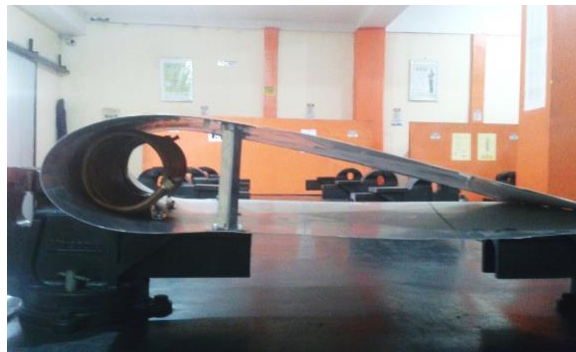
Gambar 1. Instalasi Heater Helical Coil pada Prototipe Wing
