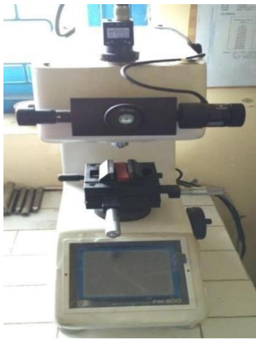
Gambar 3 Uji Kekerasan Vickers (Sumber: Politeknik Manufaktur Ceper, Klaten )
