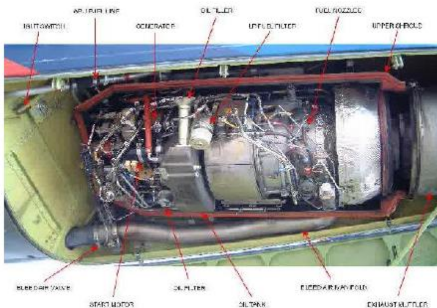
Gambar 2 APU GTCP85-129 (Sumber: www.wikipedia.wordpress.com )
