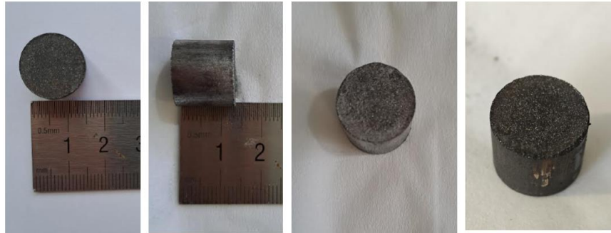
Gambar 2. Green body terdiri dari 9,59 Fe, 0,77 Cr, 0,48 Mn, 0,02 Ni, 0,23 Al, 0,23 Si, dan 0,8 Cu
