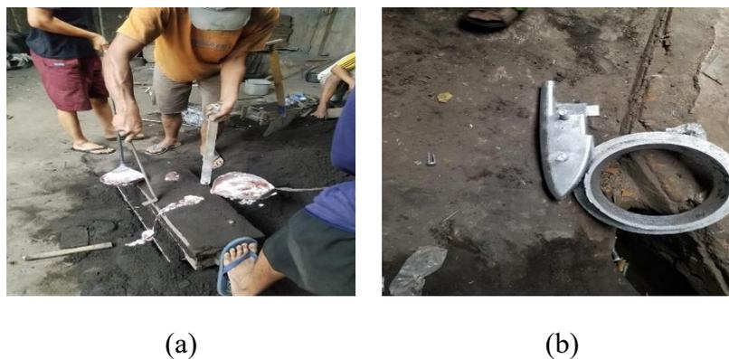
**Gambar 9. (a) Proses Penuangan Alumunium ke dalam cetakan, (b) Hasil Cetakan**
