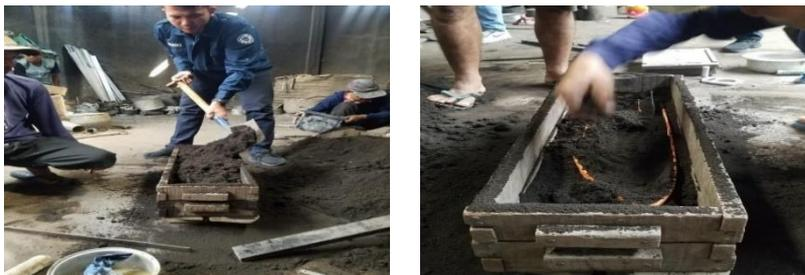
**Gambar 8. Proses Pembuatan Cetakan Aluminium**
