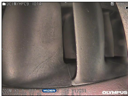
Gambar 8. Multiple Dent pada HPC 9 Rotor
