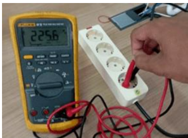
Gambar 6. Pengecekan Tegangan Input AC
