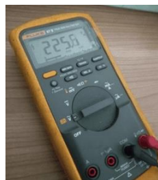
Gambar 5. Pengukuran Tegangan AC yang masuk ke PSU
