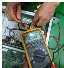
Gambar 6. Pengukuran Tegangan Output dari PSU ke modul Power Regulator
