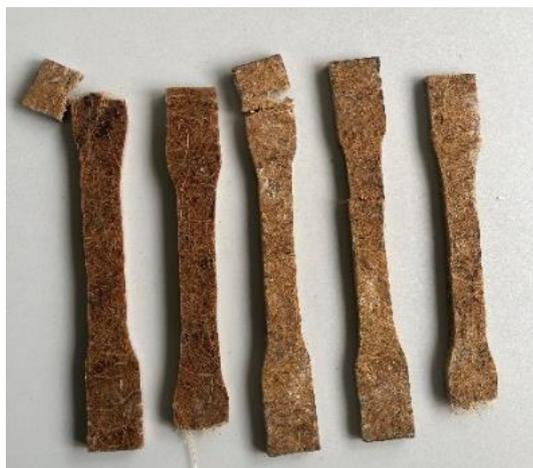
**Gambar 2. Spesimen Hasil Uji Tarik**
