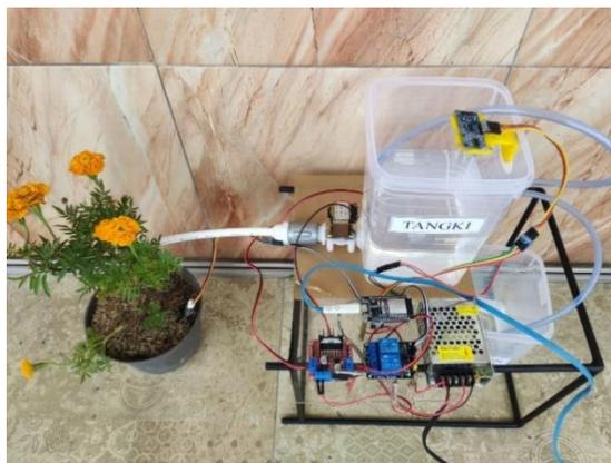
**Gambar 6. Prototype Kontrol Ketinggian Air Pada Tangki Untuk Penyiraman Tanaman**
