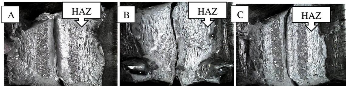
**Gambar 8. Struktur makro pada patahan las dengan pengelasan (a) kampuh V, (b) kampuh X, (c) Kampuh sejajar**
