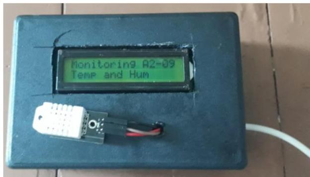
**Gambar 10. Perancangan Mekanik dan Elektronik**
