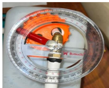
Gambar 3. Ukuran katup kran yang terbuka
