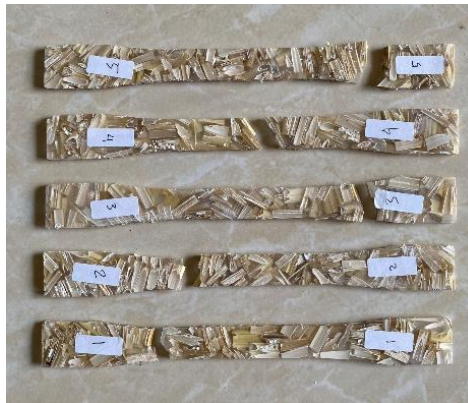
Gambar 2. Kondisi spesimen dengan arah serat acak setelah pengujian.
