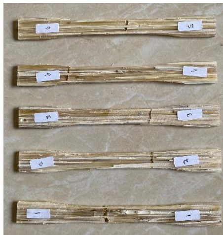
Gambar 3. Kondisi spesimen dengan serat sejajar setelah pengujian.
