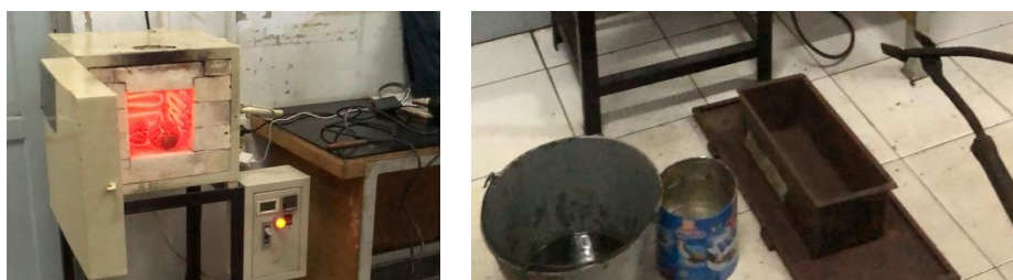
Gambar 1. Proses pemanasan spesimen dan media pendinginan setelah proses carburizing
