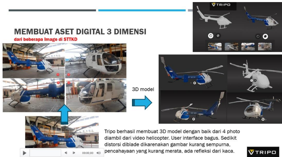
Gambar 5: Pembuatan model 3d Helikopter dari 4 gambar yang diekstrak dari frame video dengan menggunakan Tripod
