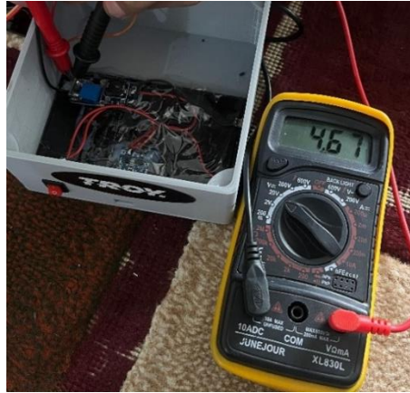
Gambar 5 Pengukuran pada Modul DC to DC Step Up
