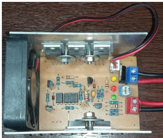
Gambar 9. Hasil pembuatan SCC dengan penambahan rangkaian FAN pendingin.
