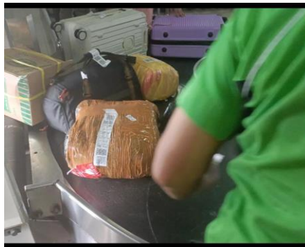
Gambar 3. Penumpukan akibat sensor tidak berfungsi
